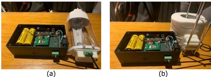
Gambar 4. Perangkat Arduino yang dirangkai dengan (a) kontainer sabun, dan (b) kontainer tisu.
