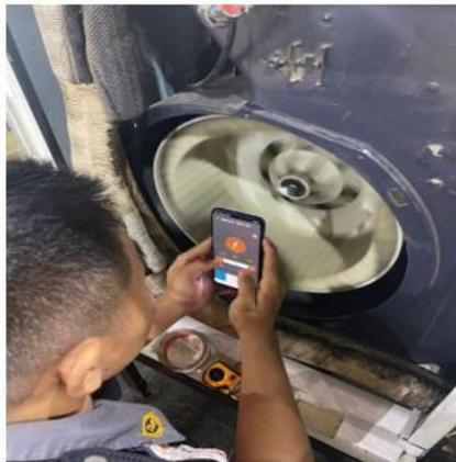
**Gambar 7.** Pengukuran RPM
