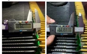
**Gambar 1.** Pengukuran Jarak *Step* Eskalator
