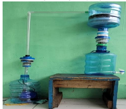
Gambar 9. Prototipe Rancang Bangun Reverse Osmosis
