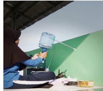
Gambar 13. Sambungkan pipa ke filter besar dan filter 2
