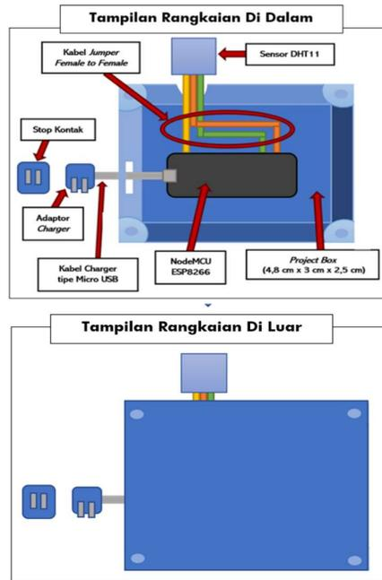
Gambar 13. Tampilan Alat yang Telah Disempurnakan
