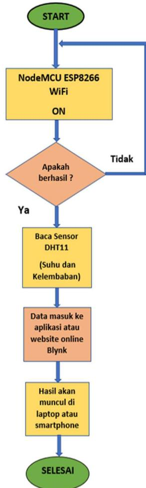
Gambar 3. Flowchart Sistem Kerja Alat
