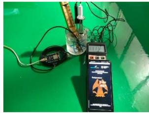
Gambar 7. Proses Pengujian Deviasi Alat Monitoring Suhu
