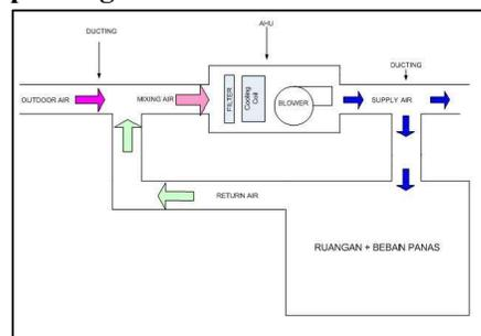
Gambar 2. Alur Kerja AHU
