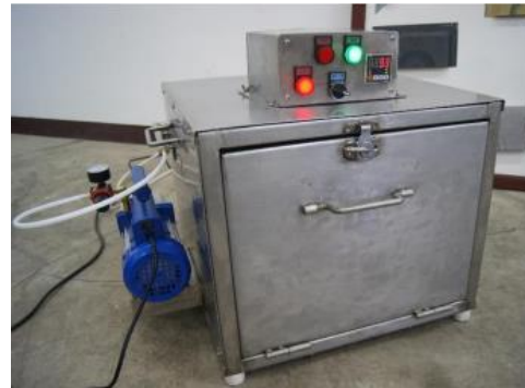
Gambar 10 Panel Kelistrikan pada Ruang pemanas
