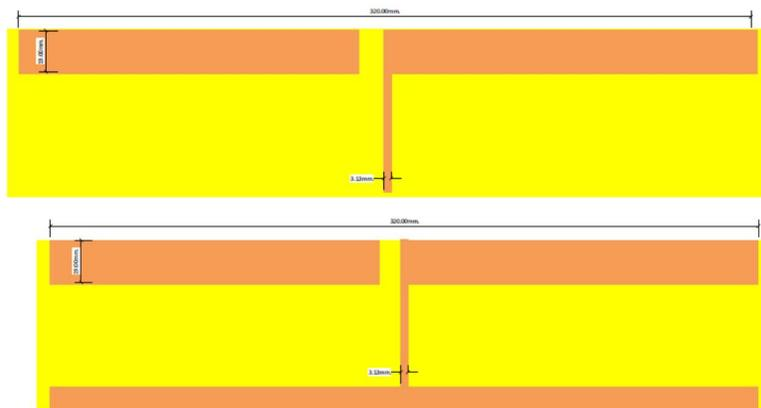
Gambar 4. Tampilan simulasi antena mikrostrip dipole
