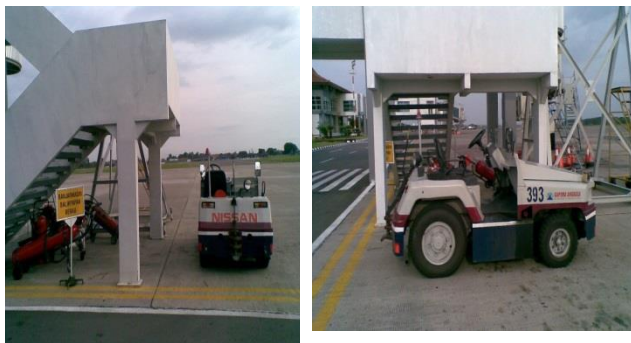
Pemarkiran GSE tidak pada tempatnya (Sumber : Dokumentasi Penulis, 6 November 2015 pukul 16.15)
