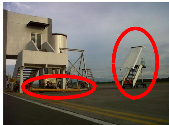
Penempatan GSE tidak pada tempatnya setelah digunakan
