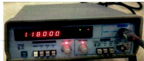
Gambar 4.15 Hasil Pengukuran 118.000 MHz dengan Frequency Counter
