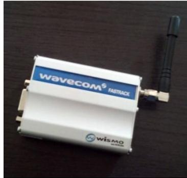
Gambar 4. Modem Wavecom
