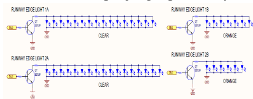
Gambar 29. Wiring Runway Edge Light
