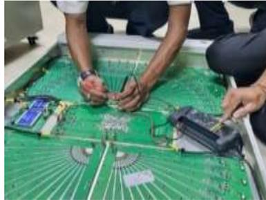
Gambar 9. Pengecekan Kontinuitas pada ASU
