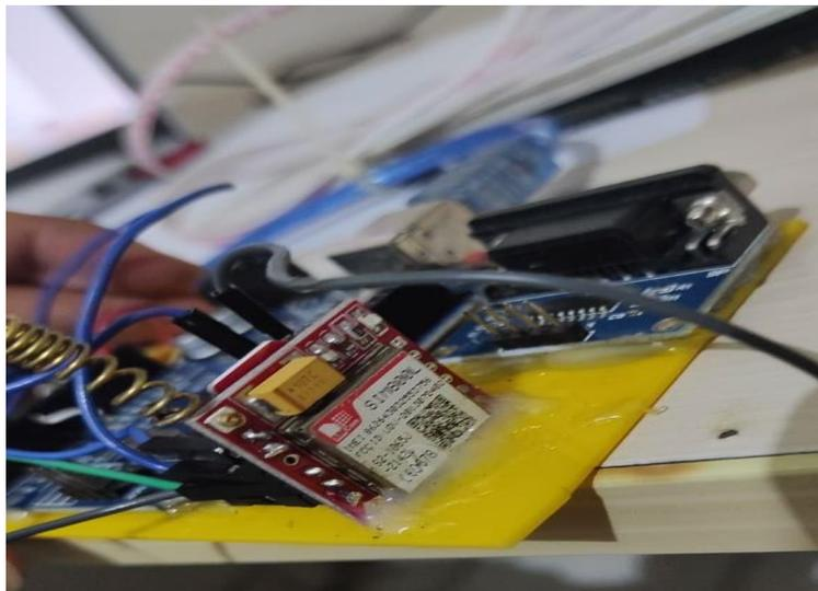
Gambar 4. GPRS Shield SIM800I
