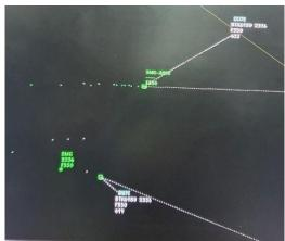
ATC System membutuhkan beberapa subsistem seperti Continuously Data Recorder (CDR), Flight Data Processing (FDP), Surveillance Data Processing (SDP) dan Radar Bypass Processing (RBP). Untuk data surveillance ATC System Tern diproses oleh SDP. SDP ATC System Airnav Jogja berasal dari tiga sumber yaitu ADSB Cilacap, Radar Jogja, Radar Semarang.
