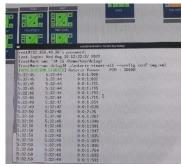
Kualitas data radar bisa dipantau dengan pengecekan waktu *delay* pengiriman data radar Semarang. *Delay* pengiriman data radar SMG ke ATC System Jogja melalui VSAT dengan jangka waktu kurang lebih 2 detik. Dipantau hasil *delay* masih di ambang batas normal.
